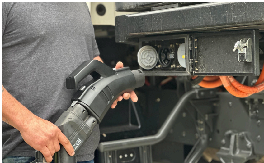
Dupla de conectores de carregamento rápido em corrente contínua (DC) no padrão GB/T, do nosso caminhão. Foto: Doug Souza / Quinze Vinte
